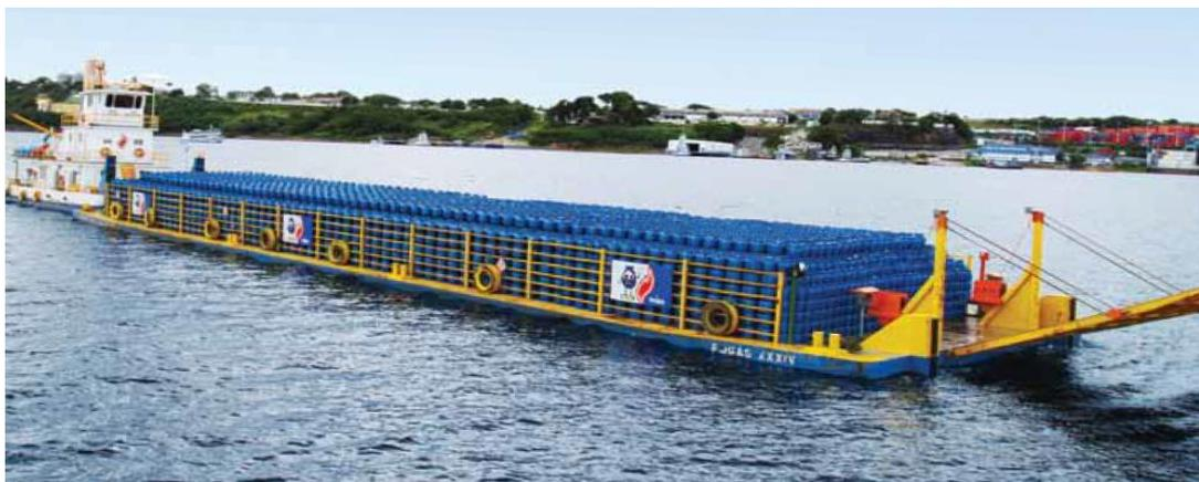
**Figura 04:** Transporte Fluvial para movimentação de GLP - *Ro Ro Caboclo*.
