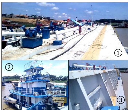
Figura 1 - 1) Balsa tanque. 2) Rebocador. 3) Casco duplo da balsa tanque.
